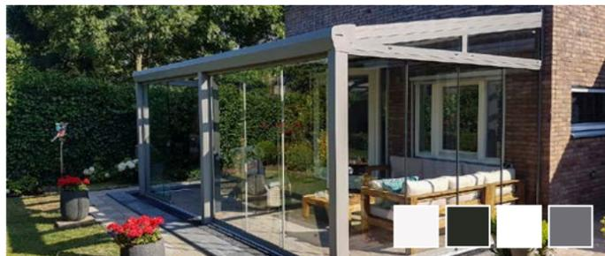
SUPREMLINE, Stabile Rinnenausführung: Pfostenabstand bis zu 6 m, variable Dachneigung 5-15°, Wasserablauf unsichtbar im Pfosten integriert, Dacheindeckungen: Polycarbonat 16 mm oder 8 mm Glaseindeckung (VSG), Rinne und Wandanschluss aus einem Stück (bis 7 m Breite) ab 3.409,- €/Stk.
