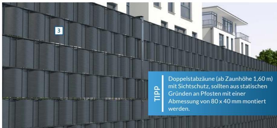
**TIPP** Doppelstabzäune (ab Zaunhöhe 1,60 m) mit Sichtschutz, sollten aus statischen Gründen an Pfosten mit einer Abmessung von 80 x 40 mm montiert werden.
