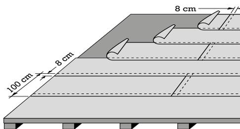
Für die Befestigung der Glasvlies-Bitumenschindeln auf Holz sind korrosionsschutzgeschützte Stifte DIN EN 10230 mit extra großem Flachkopf zu verwenden, die mindestens 25 mm lang sind.
