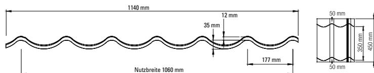
Maßgenaue Längenfertigung ohne Verschnitt!
