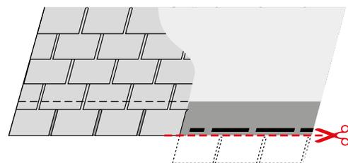
Die 1. Reihe der Decklage wird an der Traufe und Ortgang bündig auf den „Ansetzer“ aufgelegt und mit den vorhandenen Selbstklebestreifen verklebt.
