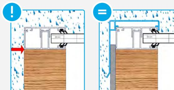
Der neue Problemlöser! Bei Terrassenüberdachungen mit Holzunterkonstruktionen müssen die äußeren Balken vor der Witterung geschützt werden. Bisher wurde dort nachträglich ein Ortgangblech aufgesetzt, was zwar funktioniert, aber nicht schön aussieht. Der Klemmdeckel mit Wetterchenkel vereint die Optik mit der Technik und sorgt dafür, dass die neuralgischen Punkte des Holzes vor Regen geschützt werden.
